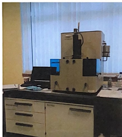
Рисунок 7 – Устройство PoreMaster с ртутным порозиметром
